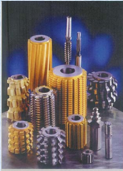
Example 1 : Gear Hobbing 例子 1 : 滾齒加工
