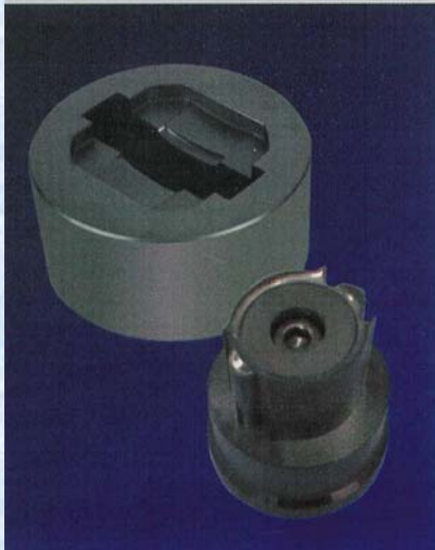
Example 4 : Punching 例子 4 : 沖壓模具
